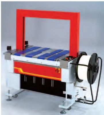
TP 601B: automatischer Band-einzug ohne Einfädeln
