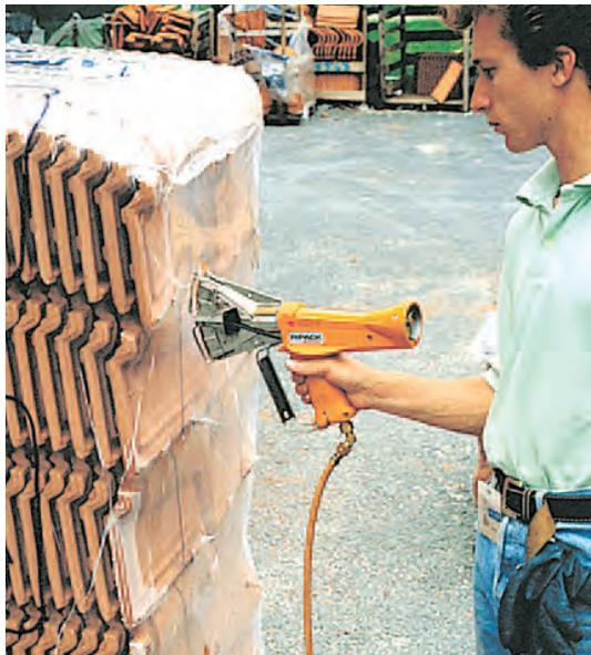
Durch einfaches Bearbeiten mit Heissluftgebläsen erhalten Sie eine wasserdichte und sehr robuste Transportsicherung
