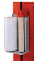
*Pre-Stretcher: angetriebene Folienvordehnung von wahlweise 100 bis 300 %*
